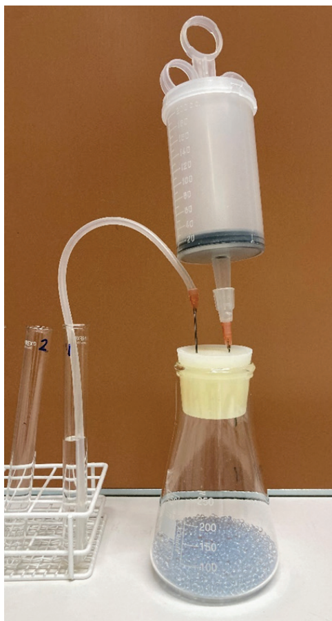
Figur 4. Provuppsättning för att binda in ammoniak som avges från kväve-askagglomerat i HCl innan titrering.
